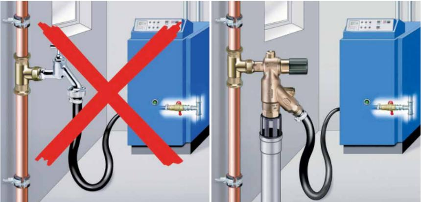
Trinkwasser-Installationen dürfen nicht unmittelbar mit Nicht-Trinkwasseranlagen (z. B. Heizungsanlage) verbunden werden, damit keine schädlichen Einflüsse auf die Trinkwasserqualität entstehen.
