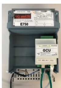
Smart Meter E750 (Sym 2 ) mit Grid Control Unit (GCU)
