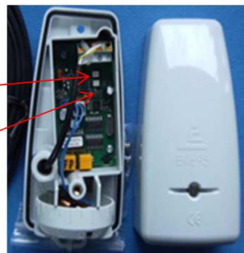
Die grüne LED zeigt die Trägerfrequenz des LW-Signals an. Sie muss permanent leuchten
